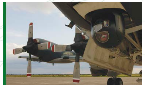
EVT-035A instalado en el avión de patrulla marina ARA P3 Orion
