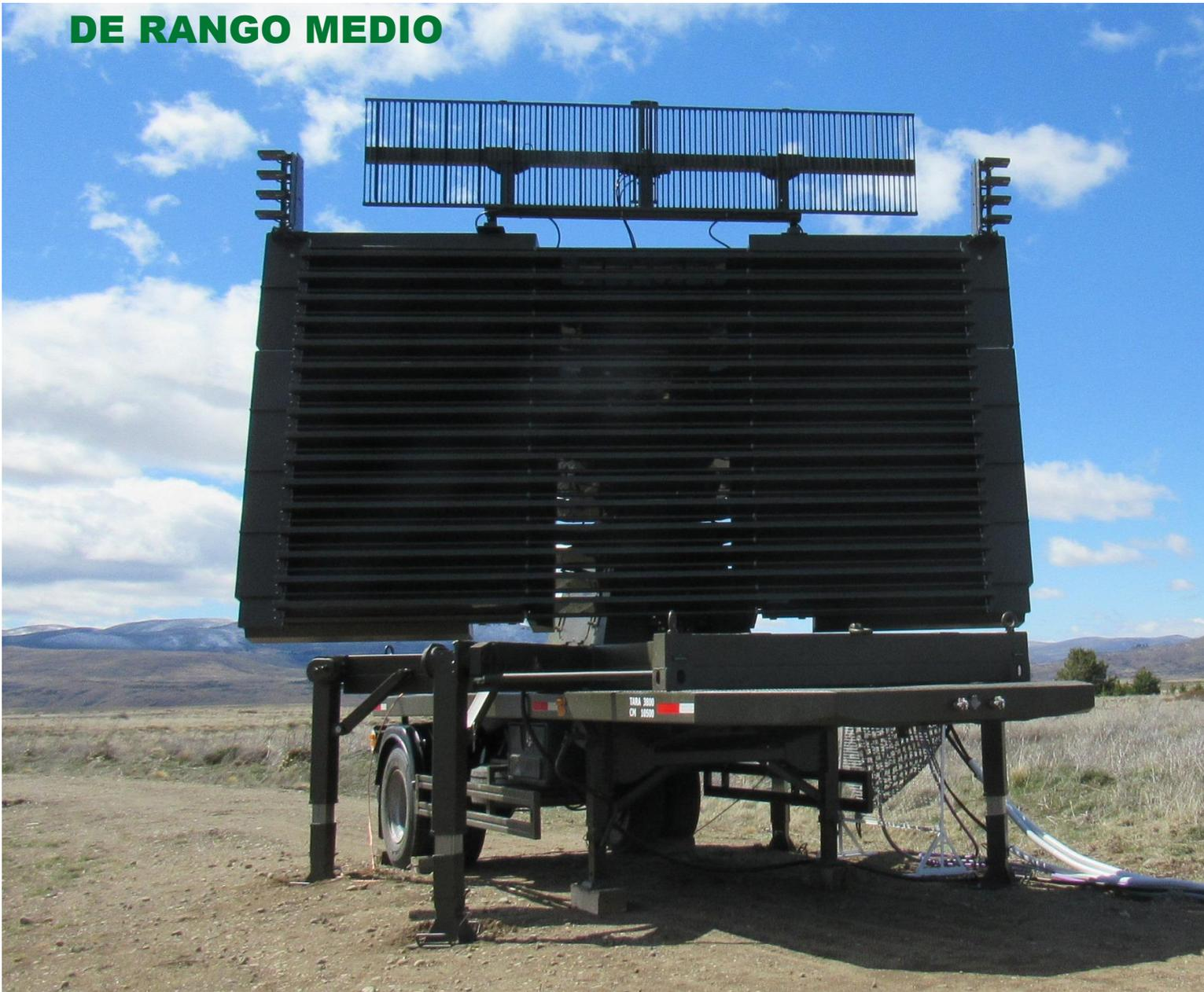
El RPA-170M es un radar táctico de defensa aérea 3D de mediano alcance de última generación que opera en banda L/D. Se trata de un sistema de alta movilidad diseñado para el despliegue rápido con mínima dotación de personal. Con tecnología del estado del arte, posee un excelente desempeño en una amplia gama de escenarios operacionales, aún en las condiciones más adversas de *clutter* e interferencias.
