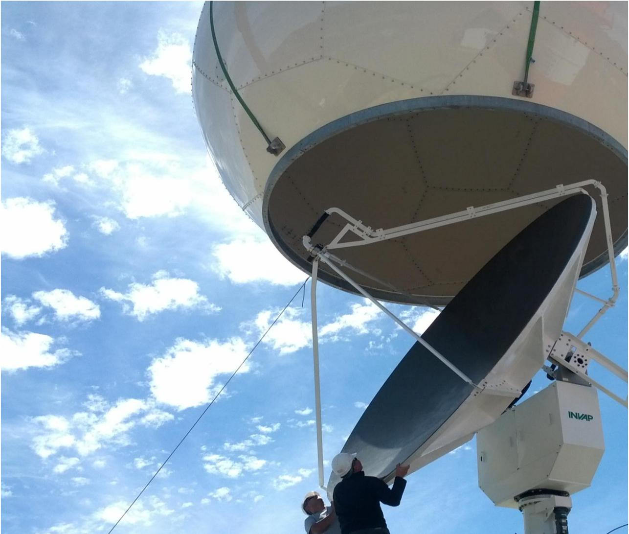
El RMA es el radar meteorológico Doppler diseñado y fabricado por INVAP. Es un radar de banda C, con transmisión y recepción en doble polarización lineal, horizontal y vertical, simultáneas.
